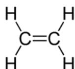
Los **alquenos** son hidrocarburos insaturados que tienen doble enlace carbono-carbono en su molécula. Se puede decir que un **alqueno** es un alcano que ha perdido dos átomos de hidrógeno produciendo como resultado un enlace doble entre dos carbonos. Los alquenos cíclicos reciben el nombre de cicloalquenos.
