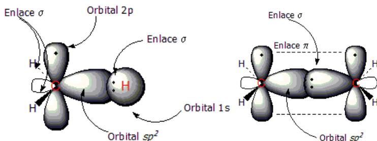
En la primera figura puede observarse el radical metilo, con un orbital  $sp^2$  que enlaza a un átomo de hidrógeno al carbono. En la segunda figura se aprecia la formación del enlace  $\pi$  (línea de puntos); **que se forma**
